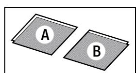
tegel wordt geplaatst. Voor plaatsing in sommige extreme omgevingen, rekening houden met de temperatuur (max. 60 °C) en de mogelijke uitzetting van het materiaal (0,07 mm/m°C).
